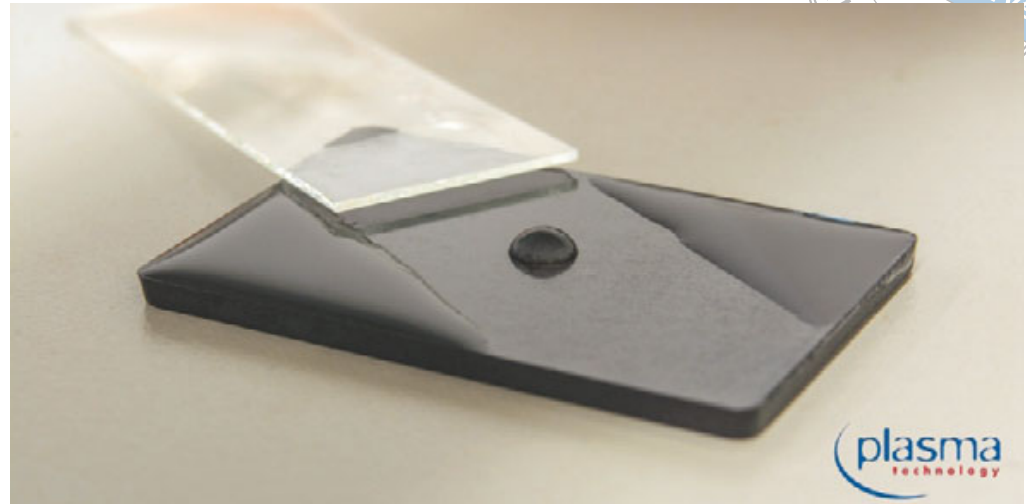
Abb. 13 Beispiel einer DLC Plasma Beschichtung (Diamond Like Carbon). Hochabrieb- und kratzbeständige, hauchdünne Beschichtung mit Diamant ähnlichen Eigenschaften. Die Zone, die unbeschichtet ist, war mit der Glasplatte abgedeckt (Quelle: Fa. plasmatechnology/Herrenberg).
