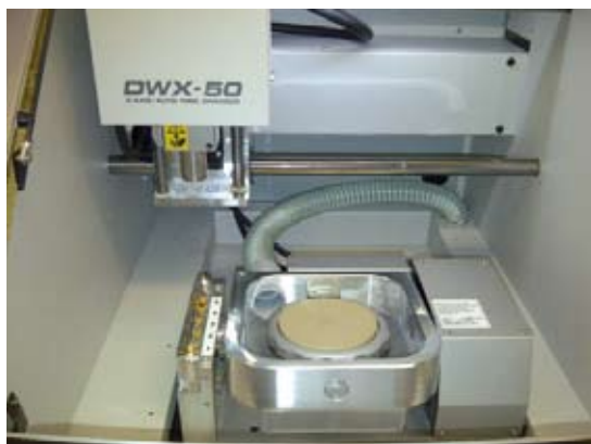
Abb. 3: Die Juvora Dental Disc wurde in den Halter einer Fünf-Achs-Fräsmaschine eingelegt.
